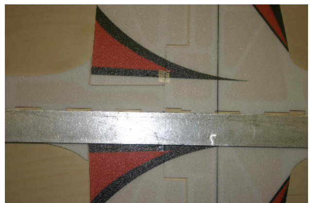
Abbildung 4: Ausrichtung Tragfläche - Heckausleger
