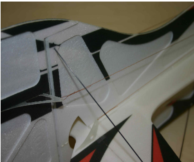
Abbildung 16: Anlenkung Seiten- und Höhenruder
