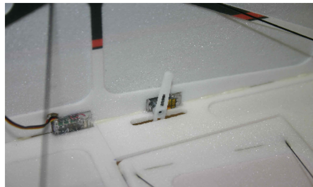
Abbildung 14: Seiten- und Höhenruderservos
